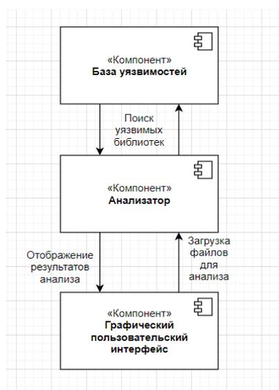
Рисунок 2. Схематическое представление компонентной архитектуры программы.
